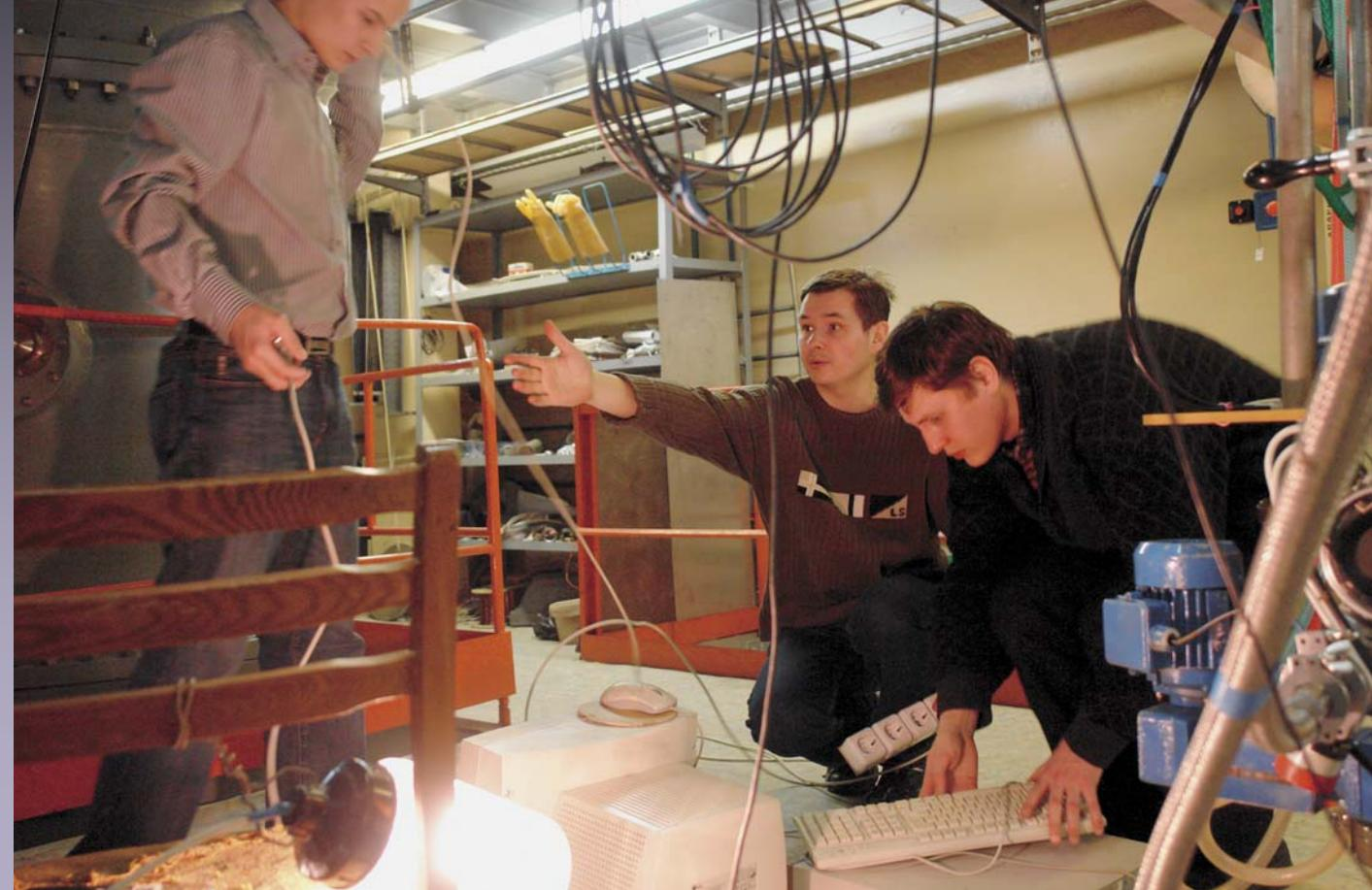
На сегодня исследователям удалось решить все физические проблемы, мешавшие создать компактный ускорительный источник для нейтронозахватной терапии рака. Таким образом, менее чем за десять лет специалисты ИЯФ СО РАН разработали и создали действующий образец установки – компактный и относительно недорогой источник нейтронов, предназначенный специально для размещения в онкологических центрах.
